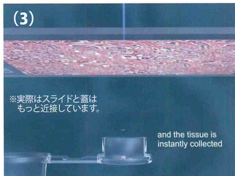
(3) エネルギー転送コーティングが気化し、その部分の組織が試薬などを入れたチューブの蓋に直接回収される。
